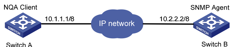
图1-6 SNMP 配置测试组网图
