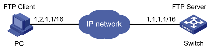
图1-2 FTP 服务器组网示意图
