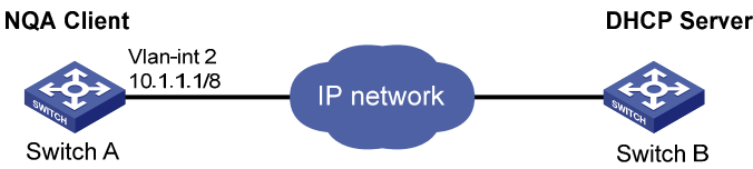
图1-2 DHCP 测试组网图
