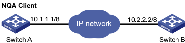
图1-1 ICMP-echo 测试组网图
