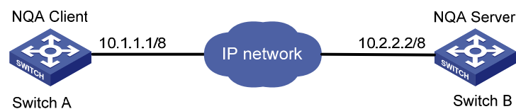
图1-5 UDP-jitter 测试组网图
