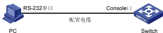
图1-1 通过 Console 口配置 Telnet 登录方式的组网图
