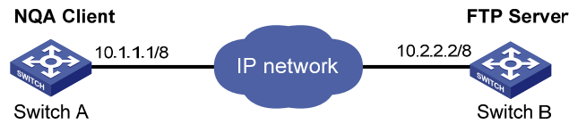
图1-3 FTP 测试组网图
